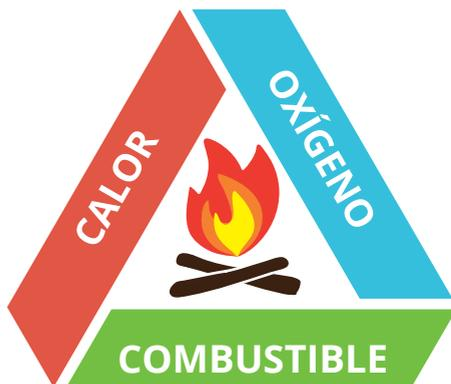
Figura 1: Triángulo del fuego
